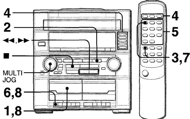
La fonction d'enregistrement avec montage et calcul du temps (AI edit recording) permet d'enregistrer des CD sans se préoccuper de la durée de la cassette et des plages. Quand un CD est inséré, l'appareil calcule automatiquement la durée totale des plages. Si nécessaire, l'ordre des plages est changé de manière à ce qu'aucune plage ne soit tronquée.
